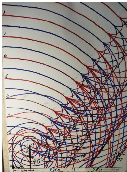
Рисунок 1 - Звуковое поле в области тени АЭ от точечного источника шума
