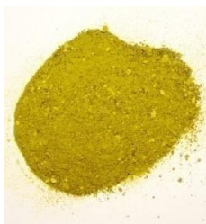
Рисунок 3 – Гидроксид железа, полученный после кислотнo-щелочной обработки гальванического шлама
