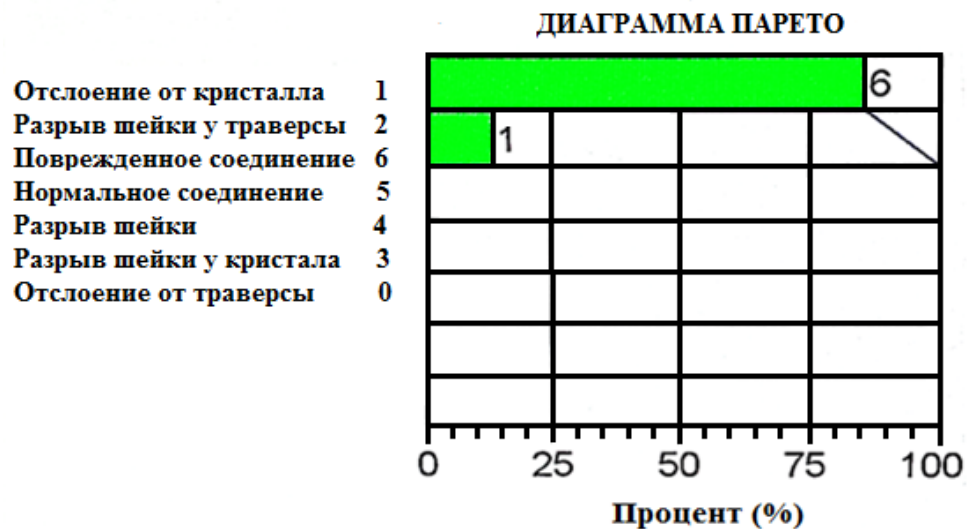
Рисунок 3 – Графический результат контроля качества сварных соединений для варианта снижения значения мощности (гистограмма - наличие разрывов и отслоек)
