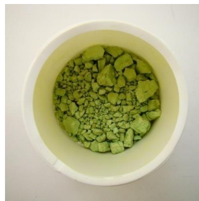
Рисунок 2 – Гальваношлам после ванн никелирования предприятия ОАО «Роберт-Бощ-Саратов»
