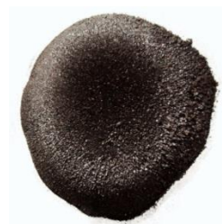
Рисунок 4 – Железная окалина (маггемит) \text{Fe}_3\text{O}_4 , обладающая магнитными свойствами
