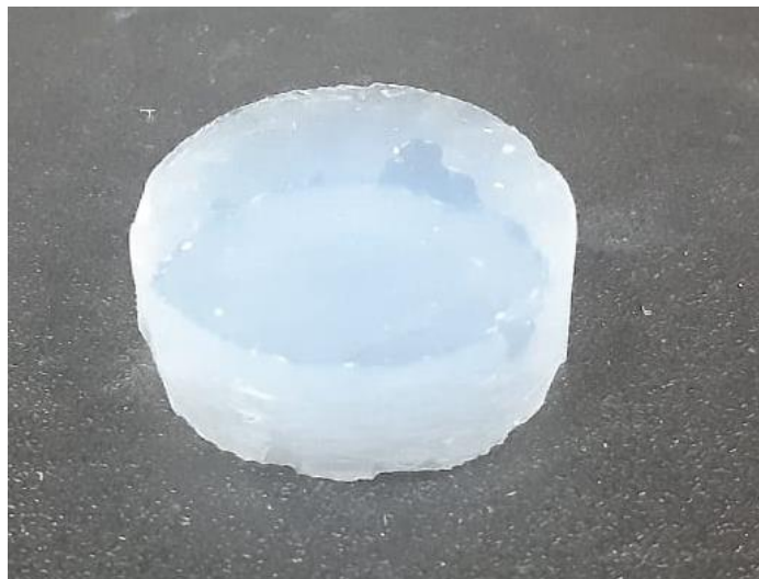
Рисунок 3 – Фото образца аэрогеля для измерений в импедансной трубе. Диаметр образца 30 мм, высота 10 мм, плотность 250 кг/м 3
